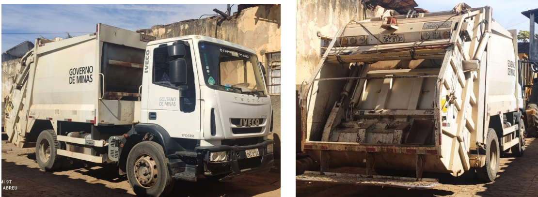
Figura 51 - Caminhão compactador empregado na coleta de resíduos sólidos
